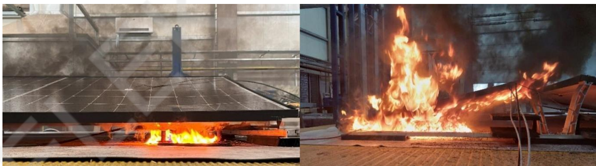
Slika 28 Širenje plamena preko LHD sustava nakon 5-6 minuta: prednji (lijevo) i bočni (desno) pogled (Fotografija (lijevo 050522d-084, desno 050522d-085))
