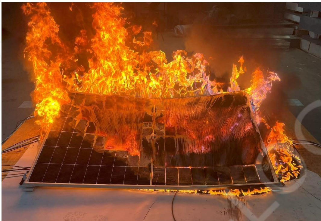
Slika 20. Fotonaponski modul obavijen plamenom, uz plave plamenove koji dolaze iz kabela (gornji desni kut) (Fotografija 050522d-030)
