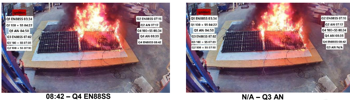
Slika 34 Snimke LHD-4 snimljene iz zraka tijekom aktiviranja alarma (bijeli okviri prikazuju vrstu LHD kabela i njihova vremena detekcije). Vremena su data u min:s. (Fotografija od 050522d-138 do 050522d-149)
