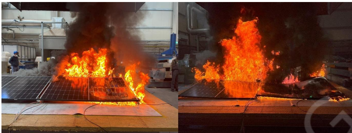
Slika 29. Plamen se proširio preko prvog PV modula (lijevo) i prema trećem i četvrtom modulu (desno), 8 minuta nakon paljenja (Fotografija (lijevo 050522d-086, desno 050522d-087))
