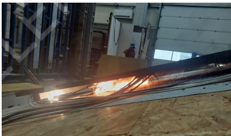
Slika 24 Opseg požara na uzorku odmah nakon zaustavljanja stvaranja luka nakon 2 minute (Fotografija 050522d-058)
