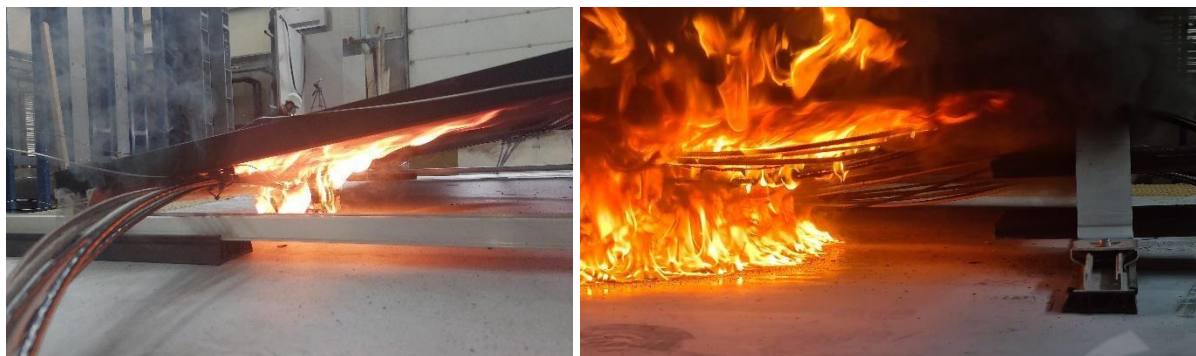
Slika 16 Detektorski kabeli u plamenu 1 minutu (lijevo) i 6 minuta (desno) nakon paljenja (Fotografija (lijevo 050522d-001, desno 050522d-002))
